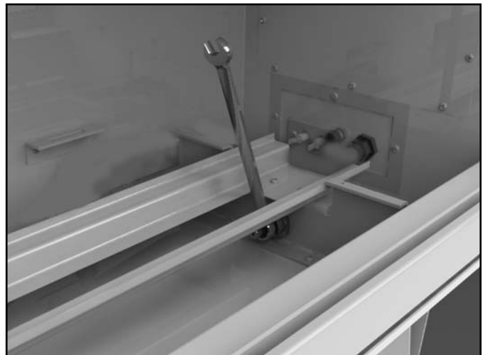
Figure 22: Remove NG Orifice
